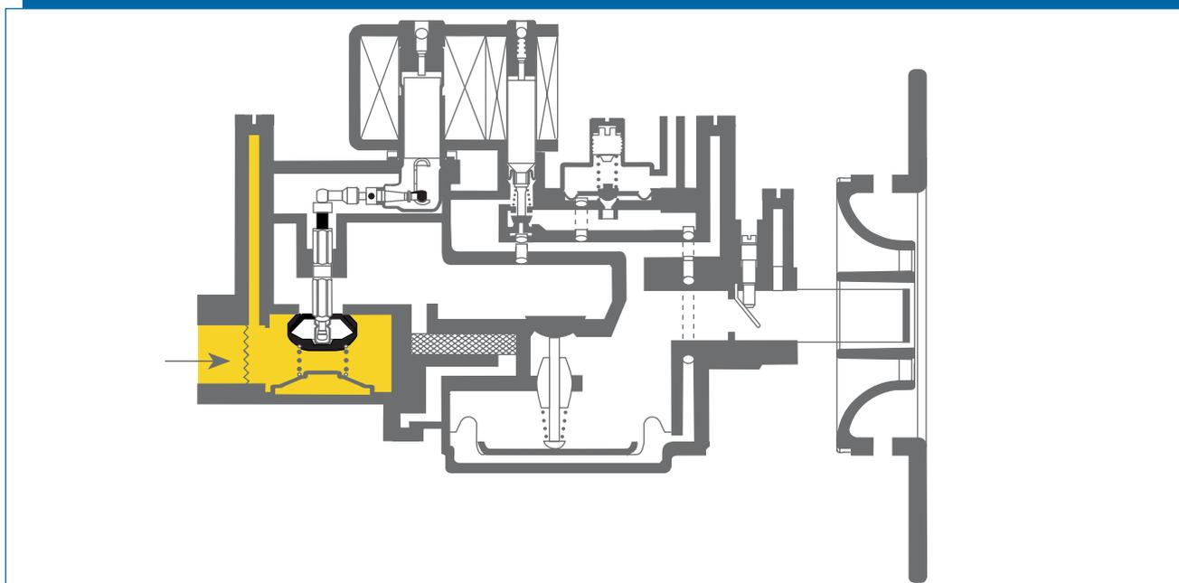
**Preventilazione** - Durante la preventilazione si innesca il flusso d'aria in 391 AGM. L'ingresso dell'aria avviene sia in senso assiale (A) che trasversale (B).
