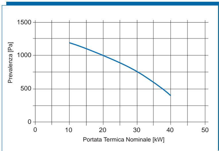
Nel diagramma seguente sono riportate le curve di funzionamento di un ventilatore modello MVL RG130 230 Vac equipaggiato con 391 AGM. La curva caratteristica riporta la prevalenza a valle del ventilatore a 6000 giri/min, aperture laterali aria completamente aperte.
